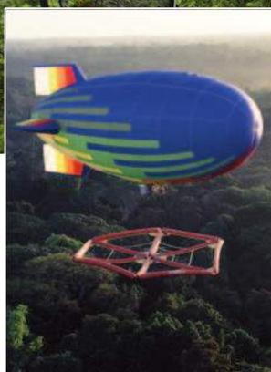
Opération Canopée, depuis sa création et l'invention du "Radeau des Cimes" il y a trente ans, conçoit, développe, et met à disposition des chercheurs du monde entier des engins volants originaux leur permettant d'accéder à la canopée des arbres des forêts tropicales humides.
